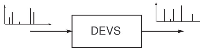
Figura 3.4: Comportamiento Entrada/Salida de un modelo DEVS.
