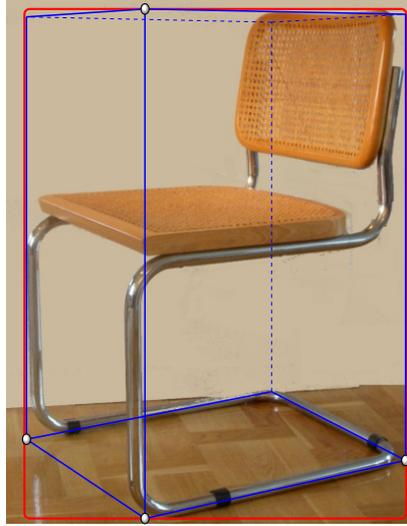
**Figura 4.1.1:** Proyección del *bounding cube* en la imagen (en azul), y vértices que determinan el *bounding box* (en rojo).
