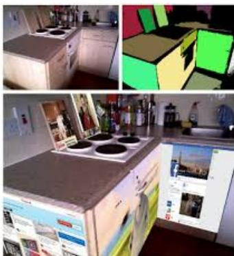
**Figura 2.2.3:** Una escena en una cocina (imagen superior izquierda), la detección de superficies planares (imagen superior derecha) por Dense Planar SLAM y una posible aplicación en realidad aumentada (imagen inferior). Imagen obtenida de [50].
